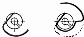
Фиг. 194. Корректировка точки заштифтовки посредством изгиба спирали.
