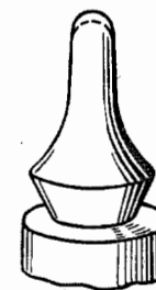
Фиг. 198. Изменение пятки цапфы оси баланса.
